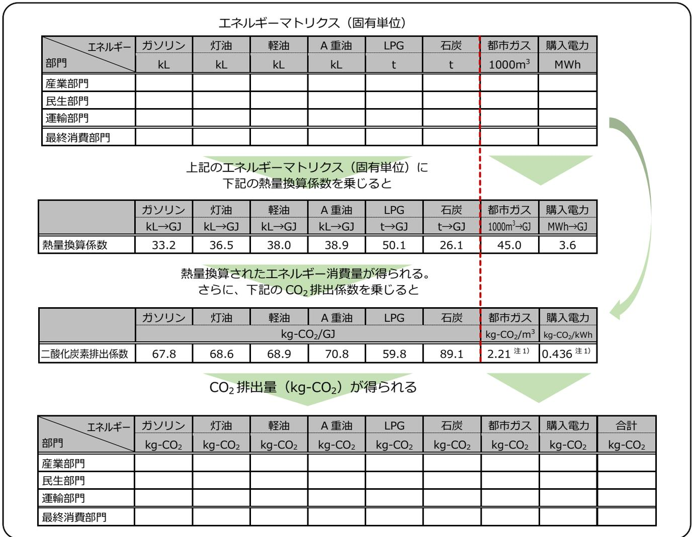
図1 エネルギーマトリクスとエネルギー消費量、CO<sub>2</sub>排出量の算出
